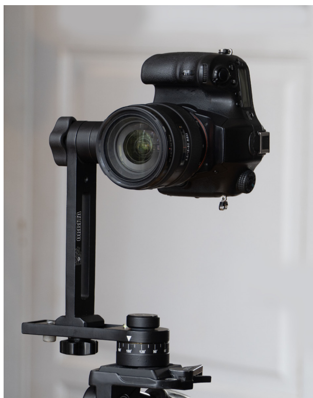
Рис. 3. Фотоаппарат, установленный на нодальную штативную головку (фото Г. А. Мажуги 2025)
